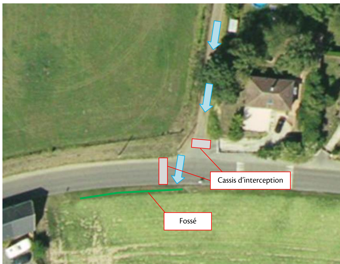
Figure 69. Aménagement d'un cassis d'interception et d'un bassin d'infiltration dans la rue du Bourgain et la rue Raymond Faroux
